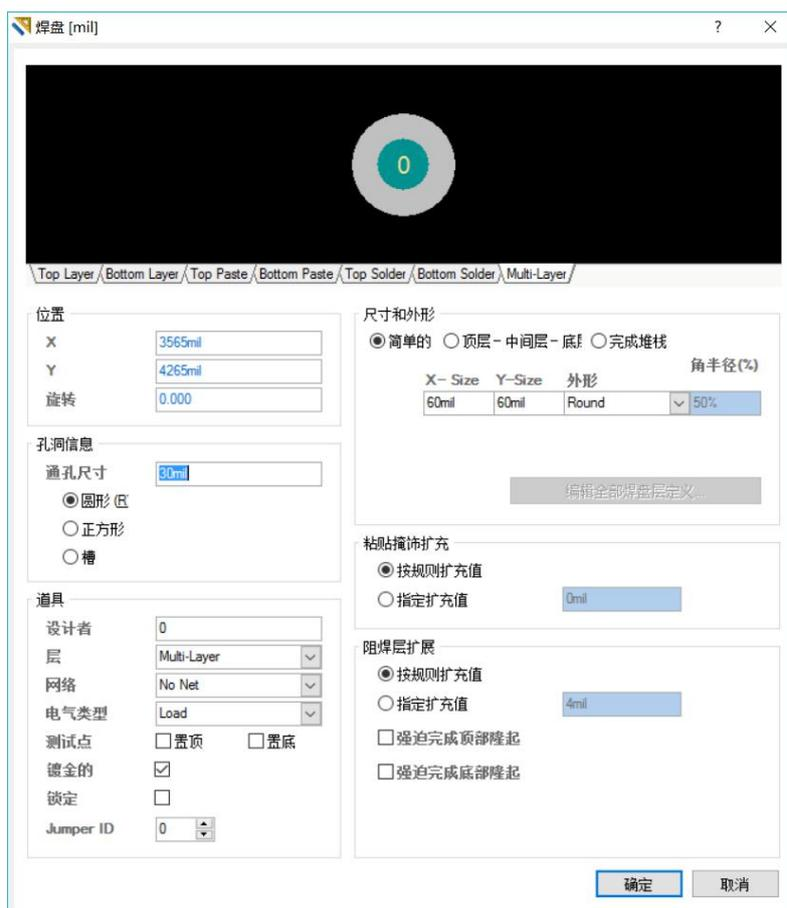
图 5-26 焊盘属性设置对话框
