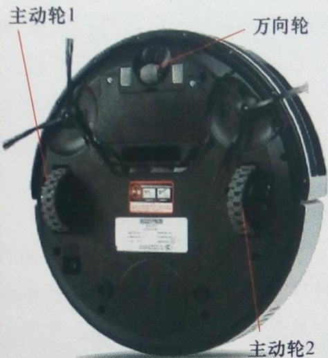
c) 三轮行走iRobot清扫机器人
