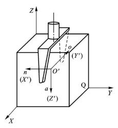
解:因为物体 Q 形心与手部坐标系 O'X'Y'Z'的坐标原点 Q'相重合,所以手部位置的  $(4\times1)$  列阵为:  $P=[1\,1\,1\,1]T$
